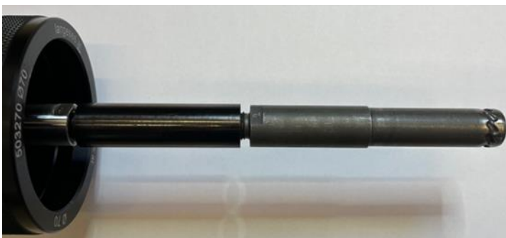
Foto 06: Stelo del cilindro, prolungamento, bullone di accoppiamento (da sinistra a destra)
